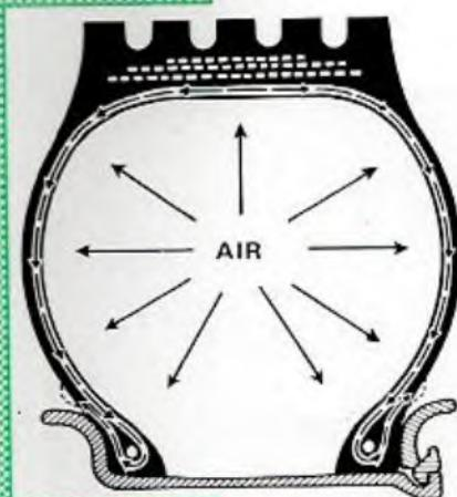
Le montage sur jante Tubeless de pneus avec chambre, montés sans chambre à air peut entraîner des avaries néfastes pouvant aller jusqu'au déroulement de la nappe dans la zone d'accrochage (autour de la tringle) avec les risques d'accidents graves qui s'y rattachent.
