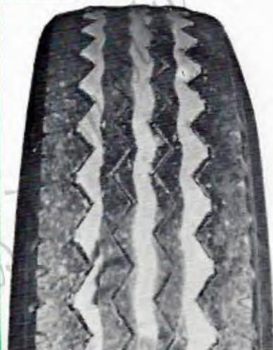
Zone d'usure circulaire n'intéressant pas toute la largeur de la bande de roulement.
