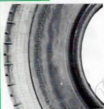
Le contact de deux pneus provoque une usure circulaire des flancs. Lorsque ce contact est trop important, il peut se produire une dégradation entraînant une mise hors service rapide des deux pneus.
