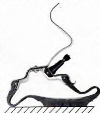
L'usure circulaire visible sur le milieu du flanc provient d'un contact de cette partie du pneu avec le sol par suite de l'affaissement anormal de la carcasse dû à une pression de gonflage nettement insuffisante.
