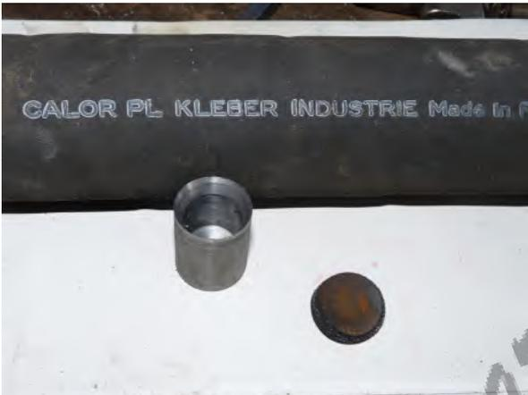
Un trou de 21mm a été réalisé au paravent dans la durite à l'emporte pièce pour que ça s'emboîte en force.
