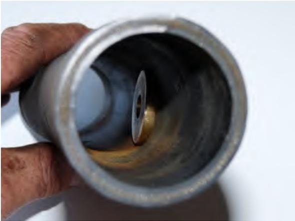
La partie mâle est insérée dans la durite puis mise en place à la presse qui appuie la durite autour de la partie filetée.
