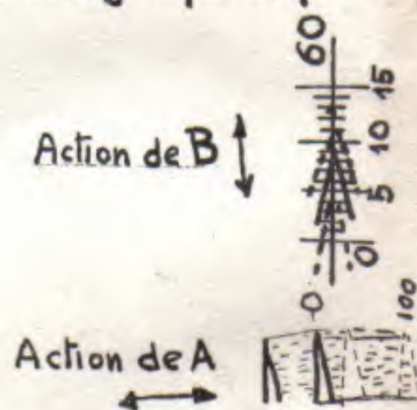
Figure 3. Positionner la roue de façon que la jante intérieure soit dans une position telle qu'en dernière opération la masse d'équilibrage statique soit à l'aplomb de la pique. Aucun déplacement du plateau ne doit être fait après l'équilibrage dynamique.
