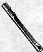
Bouterolle pour rivets tubulaires
