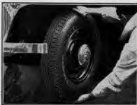
Faites vérifier et régler le jeu des roulements des roues avant.
