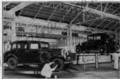
Les Postes de Graissage sous pression.
