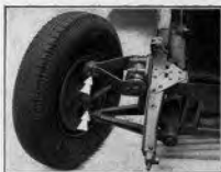
Rotules d'articulation des bras de suspension sur la fusée. 4 points
