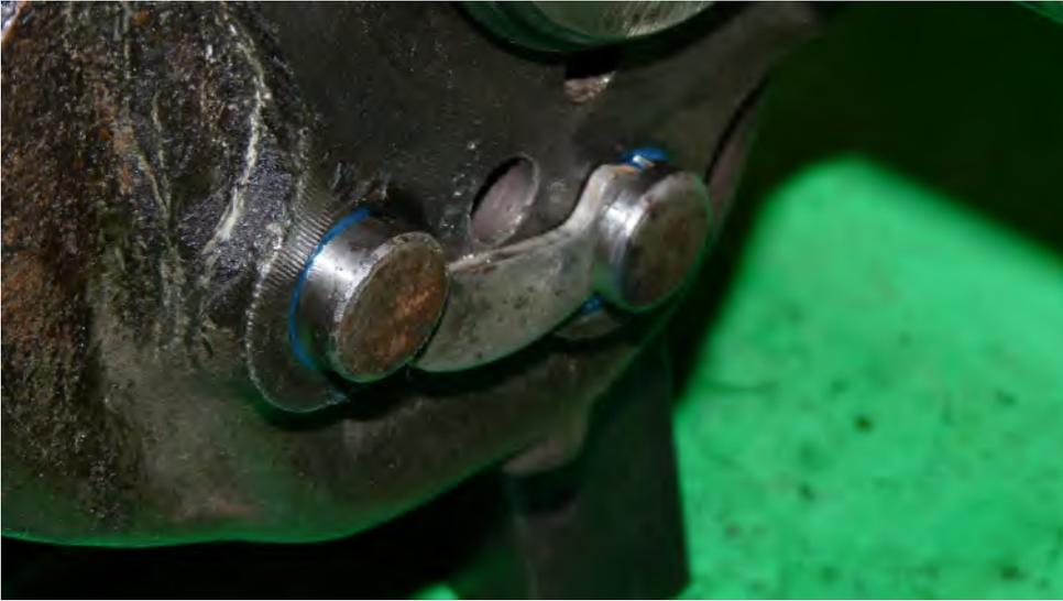
*Il sera fait de même avec les roulement pour limiter le risque de tourner dans leur logement.
